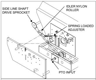
FIGURE 12. SIDE SHAFT CHAIN DRIVE
