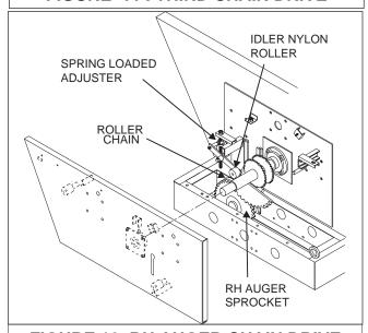
FIGURE 10. RH AUGER CHAIN DRIVE
