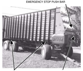
EMERGENCY STOP TRIP CABLES EXTENDING ALONG BOTH SIDES
