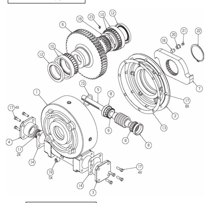
Use #85W140 wt. Gear Lube Oil <u>ONLY</u>. <u>DO NOT</u> USE GREASE FOR LUBRICANT.
