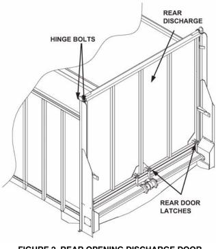
FIGURE 2. REAR OPENING DISCHARGE DOOR CAUTION - QUICK RELEASE
