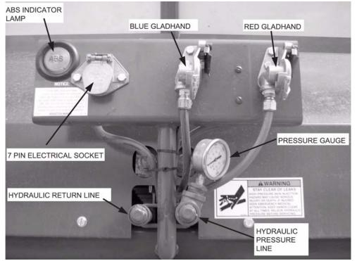
FIGURE 1. ELECTRICAL LIGHT AND AIR BRAKE HOOKUP
